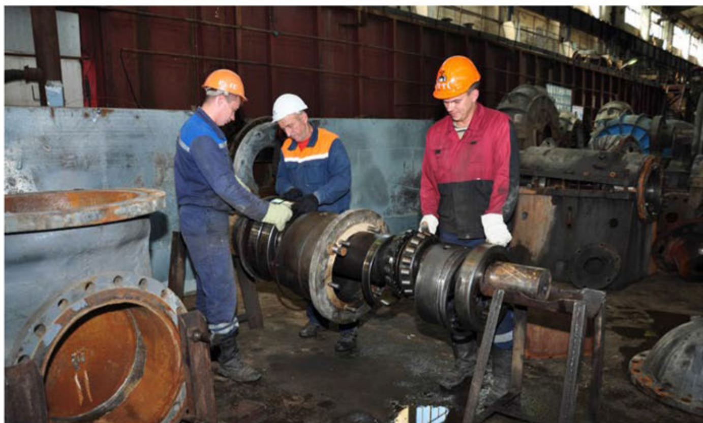
Ремонт ротора балерного насоса ведут слесарь АВП Александр Анатольевич Федоров, начальник смены Анатолий Михайлович Брокер и слесарь КППЦ Валерий Сергеевич Сенник
