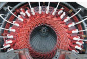
По фиберпластиковым трубкам (окрашены в белый) дистиллированную воду подают в провода обмотки статора (окрашены в красный цвет)
