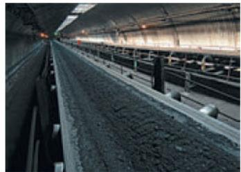
Конвейеры поднимают уголь из подземного распределителя и транспортируют к месту его дальнейшего использования или складирования
