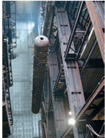
Это паровой барабан в «чистом виде» — до его монтажа и обмуровки. Чтобы выдержать давление в 150 кг/см<sup>2</sup>, стены парового барабана должны быть очень толстыми и изготавливаться из специального сплава, устойчивого к большим температурам. Толщина стенок парового барабана ТЭЦ-3 — 11 сантиметров. Это на 2 сантиметра больше, чем лобовая броня легендарного танка Великой Отечественной войны — Т-34 (9 сантиметров)
