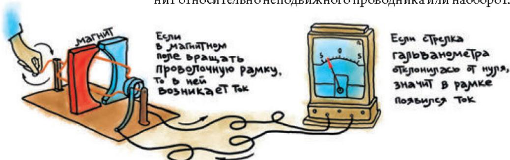
Важен результат — изменяющееся магнитное поле наводит (индукция, собственно, и означает наведение) в проводнике электрическое поле, оно, в свою очередь, порождает электрический ток соответственного направления и силы. Как вы уже, наверное, успели догадаться, направление индукционного тока будет меняться с такой же частотой, с какой магнит будет приближаться/удаляться от проводника, а сила будет зависеть от того, насколько велики показатели магнитного поля.
